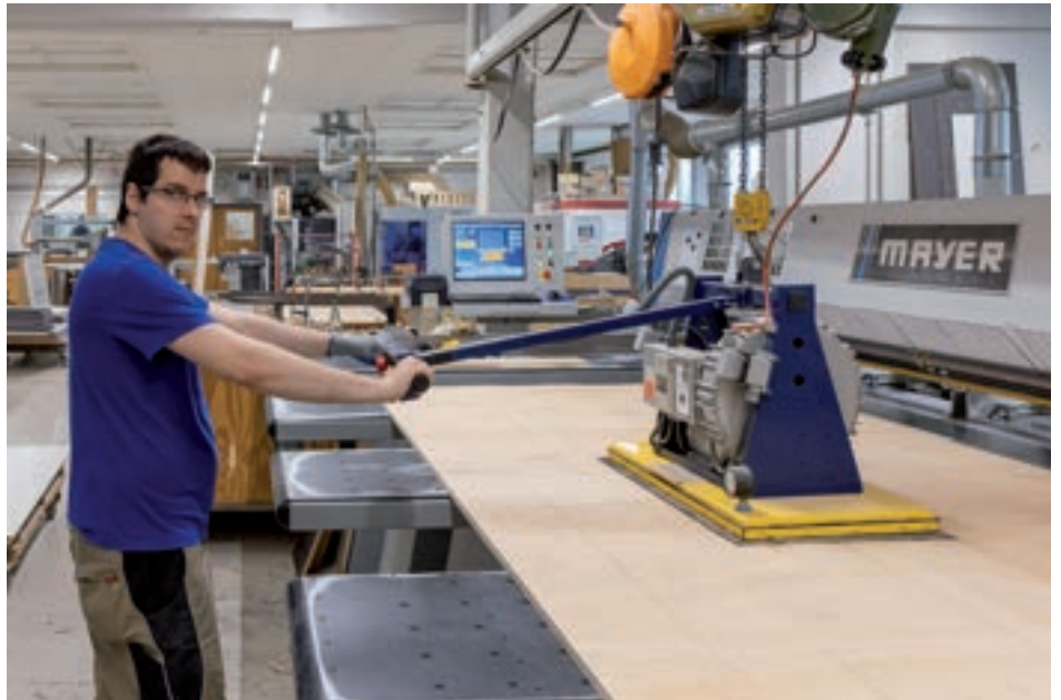
Auflegen der Plattenwerkstoffe
